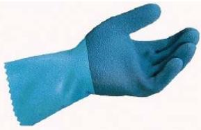
A cinque dita e lunghezza totale di 25-30 cm min., realizzati con materiali tali da garantire il massimo comfort e destrezza, impermeabili, supporto tessile interno, resistenti al calore (100 °C) e freddo per contatto, livello di prestazione meccanica minimo 3141 (pittogramma presente sul DPI), livello di prestazione al calore e fuoco minimo X1XXXX (pittogramma presente sul DPI).
